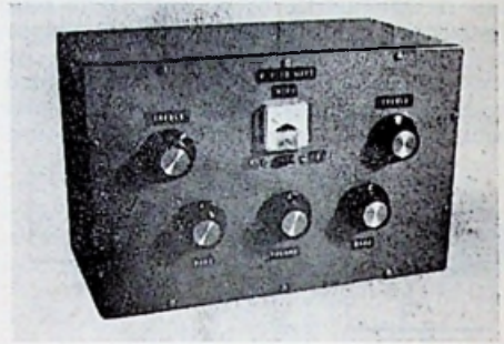
Afb. 1 - De 2 x 15 watt stereoversterker vormt een geïntegreerde eenheid in een stevige metalen kast van sobere constructie.
